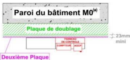
Cas N°3 Panneau de contrôle fixé sur plaque de doublage avec deuxième plaque de plâtre
