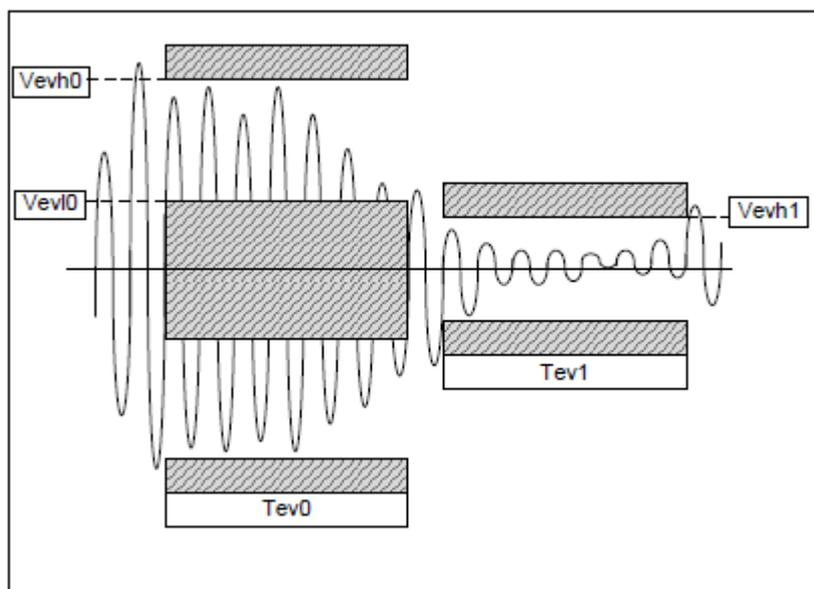
Figure 2 - Caractéristiques de l'enveloppe de la porteuse
