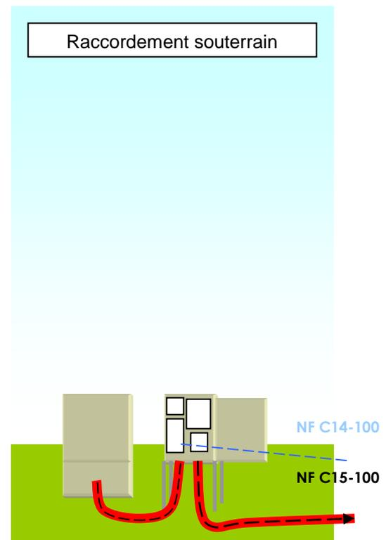
Le raccordement est réalisé sur un terrain équipé d'un organe de réseau basse tension fixé au sol sur lequel il est possible de connecter le nouveau branchement provisoire.
