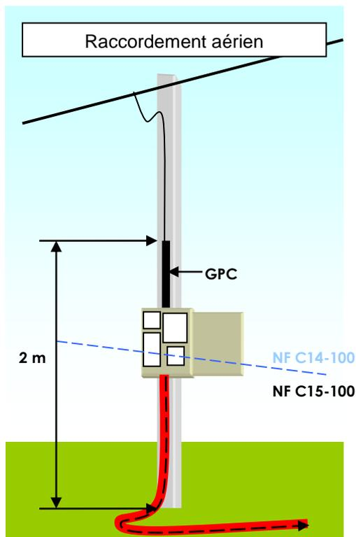
Le raccordement provisoire est réalisé sur un terrain ne comportant aucune borne (ou organe de réseau) fixée au sol. En règle générale, le branchement est réalisé sur un réseau aérien.
